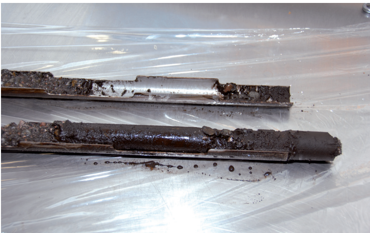
Abbildung 12. Das Innenrohr des neuen aufklappbaren Kraki-Bohrers.
