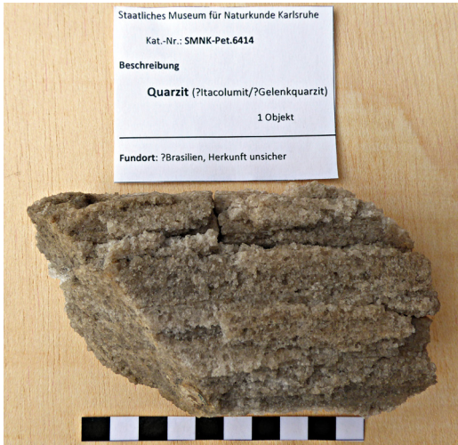
Abbildung 3. Fraglicher Itacolumit mit sehr starkem Zerfall aus der petrographischen Sammlung des SMNK, SMNK_Pet.6414. – Foto: D. FALK.
