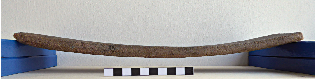
Abbildung 1. Die Biegsamkeit der Itacolumite (flexible Sandsteine); Sammlungsobjekt SMNK_Pet.6413A; Maßstab = 1 cm pro Segment. – Foto: D. FALK.
