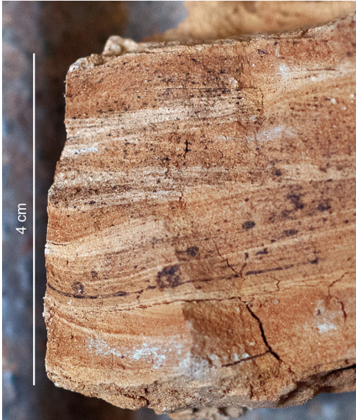
Abbildung 6. Bildausschnitt mit Kreuzschichtung in LE 72 (Kernabschnitt 13,76-13,71 m).
