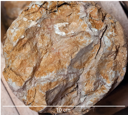
Abbildung 7. Ockerfarben-olivgrüne Marmorierung der Farben in LE 14 (Kernabschnitt 43,83-41,00 m).
