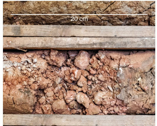
Abbildung 20. Übersicht über das Kernstück der LE 15, dem Albstein (Kernabschnitt 41,00-40,71 m).
