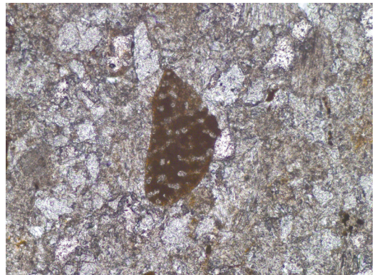
Abbildung 33. Pflanzenreste? unter dem Mikroskop ohne Analysator in Dünnschliffprobe DS 2 (Kernabschnitt 48,50-48,43 m).
