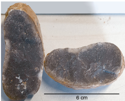
Abbildung 23. Gerölltyp 4 aus Schwarzjura-Kalkstein aus LE 78 (Kernabschnitt 12,24-11,00 m).
