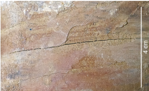
Abbildung 4. Feinlamierte Schichtung in LE 73 (Kernabschnitt 13,71-13,32 m). – alle Fotos: V. BRAUN.
