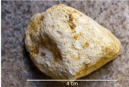
Abbildung 22. Gerölltyp 1 aus Weißjura-Kalkstein aus LE 1 (Kernabschnitt 50,00-49,22 m).
