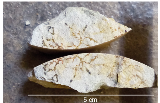
Abbildung 13. dendritische Mangan- und Eisenoxid-Abscheidungen in LE 12 (Kernabschnitt 44,51-44,22 m).
