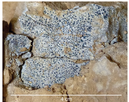
Abbildung 12. Punktförmige Manganoxid-Abscheidungen in LE 57 (Kernabschnitt 18,98-18,73 m).
