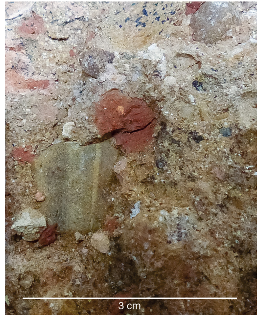
Abbildung 15. Rotbrauner Tonklast in LE 32 (Kernabschnitt 29,32-29,10 m).
