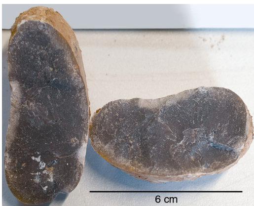
Abbildung 23. Gerölltyp 4 aus Schwarzjura-Kalkstein aus LE 78 (Kernabschnitt 12,24-11,00 m).
