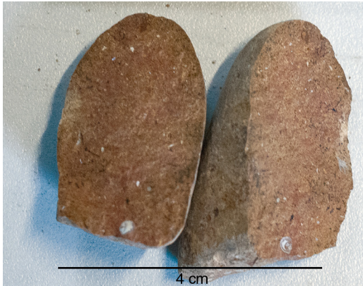
Abbildung 25. Gerölltyp 8 aus Braunjura-Kalkstein mit Bioklasten aus LE 79 (Kernabschnitt 11,00-10,00 m).
