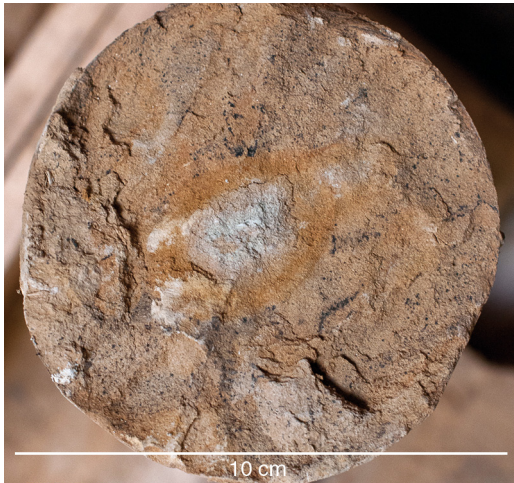
Abbildung 16. Zweiwertiges Eisen als hellgraue Verfärbungen in der Mitte der Kernbruchfläche in LE 42 (Kernabschnitt 27,25-26,97 m).
