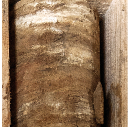
Abbildung 5. Linsenschichtung der LE 70 (Kernabschnitt 14,19-13,96 m).
