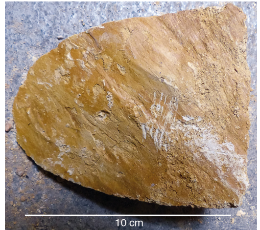
Abbildung 11. Tektonisch bedingte Rutschungsflächen (Harnische) in LE 3 (Kernabschnitt 48,99- 48,31 m).
