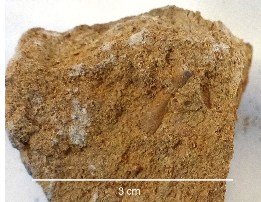
Abbildung 19. Hellbrauner Grab- oder Wühlgang (1,1 cm lang und 0,4 cm \emptyset ) in LE 3 (Kernabschnitt 48,99-48,31 m).
