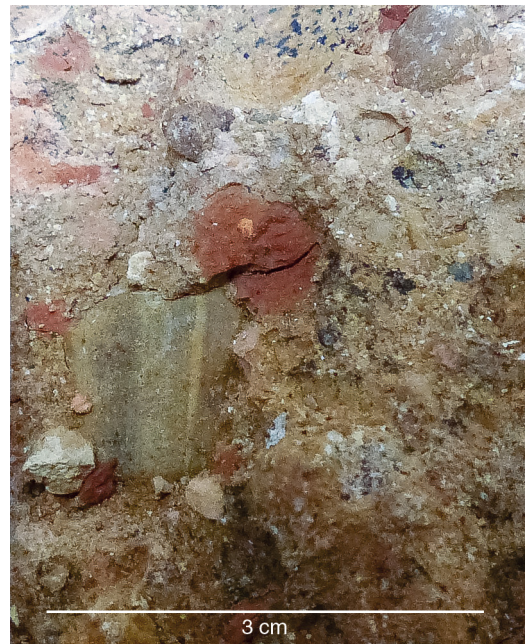
Abbildung 15. Rotbrauner Tonklast in LE 32 (Kernabschnitt 29,32-29,10 m).
