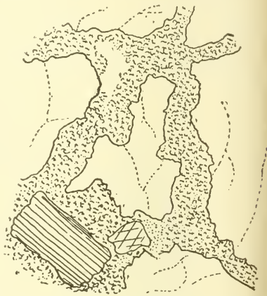
Fig. III. Kalksilicatsandstein. Corrosionserscheinungen am Quarz.
