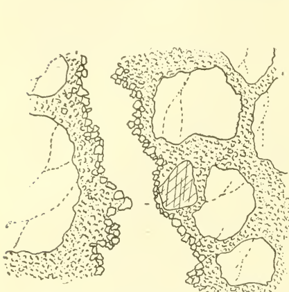
Fig. II. Kalksilicatsandstein. Porentapezirung durch Kalkspath.
