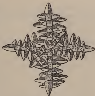
Skelettkristall von Roheisen. Natürl. Gr. etwa 3 mm.
