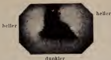
Vergr. 50. Spannungen am Einschluß in Britanniametall heller und dunkler (blau bezw. rot).
