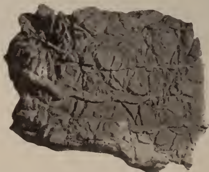
Fig. 8. Korrodierte Oberfläche, entstanden bei Behandlung mit Salzsäure. Dolomit von Čabar (Kroatien).
