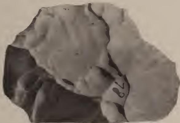
Fig. 6. Korrodierte Oberfläche, entstanden bei Behandlung mit Salzsäure. Kalkstein von Petrovo selo (Kroatien).
