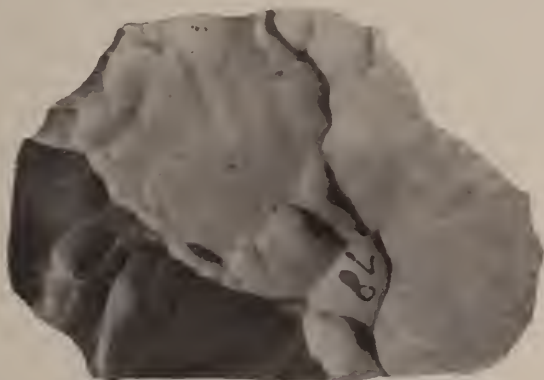
Fig. 6. Korrodierte Oberfläche, entstanden bei Behandlung mit Salzsäure. Kalkstein von Petrovo selo (Kroatien).
