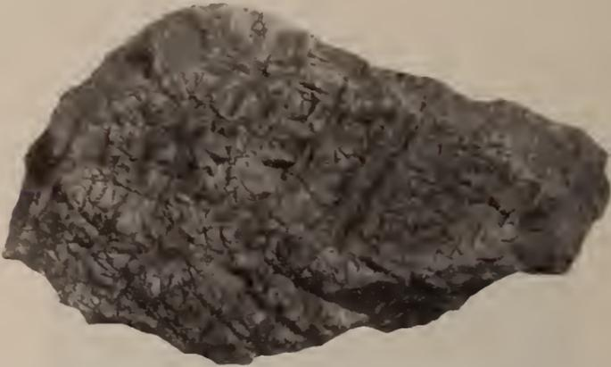
Fig. 4. Korrodierte Oberfläche, entstanden durch atmosphärische Wirkungen. Dolomit von Čabar (Kroatien).
