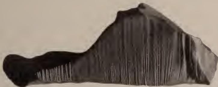
Fig. 7. Rinnenförmige Austiefungen, entstanden bei Behandlung mit Salzsäure. Kalkstein von Bakar (kroatisches Küstenland).
