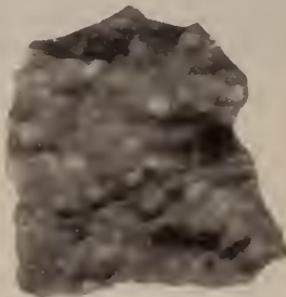
Fig. 5. Korrodierte Oberfläche, entstanden bei Behandlung mit Salzsäure. Nummulitenkalkstein von Bakar (kroatisches Küstenland).
