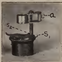
Fig. 2. Vorrichtung zum Ablenden des Sehfeldes bei direkter Beobachtung der Interferenzbilder von einem winzigen Korn nach der LASAULX'schen Methode. Zwei Blenden S_1 und S_2 , welche rechtwinklig zueinander verschoben werden können, gestatten dem Beobachter, das Licht von irgend einem Teile des Sehfeldes abzuschließen. Vor der Beobachtung der Interferenzbilder wird das Bild vom Objektiv zuerst in Übereinstimmung mit der von S_1 und S_2 gebildeten Blendebene gebracht, und zwar mittels der Lupe „a“.
