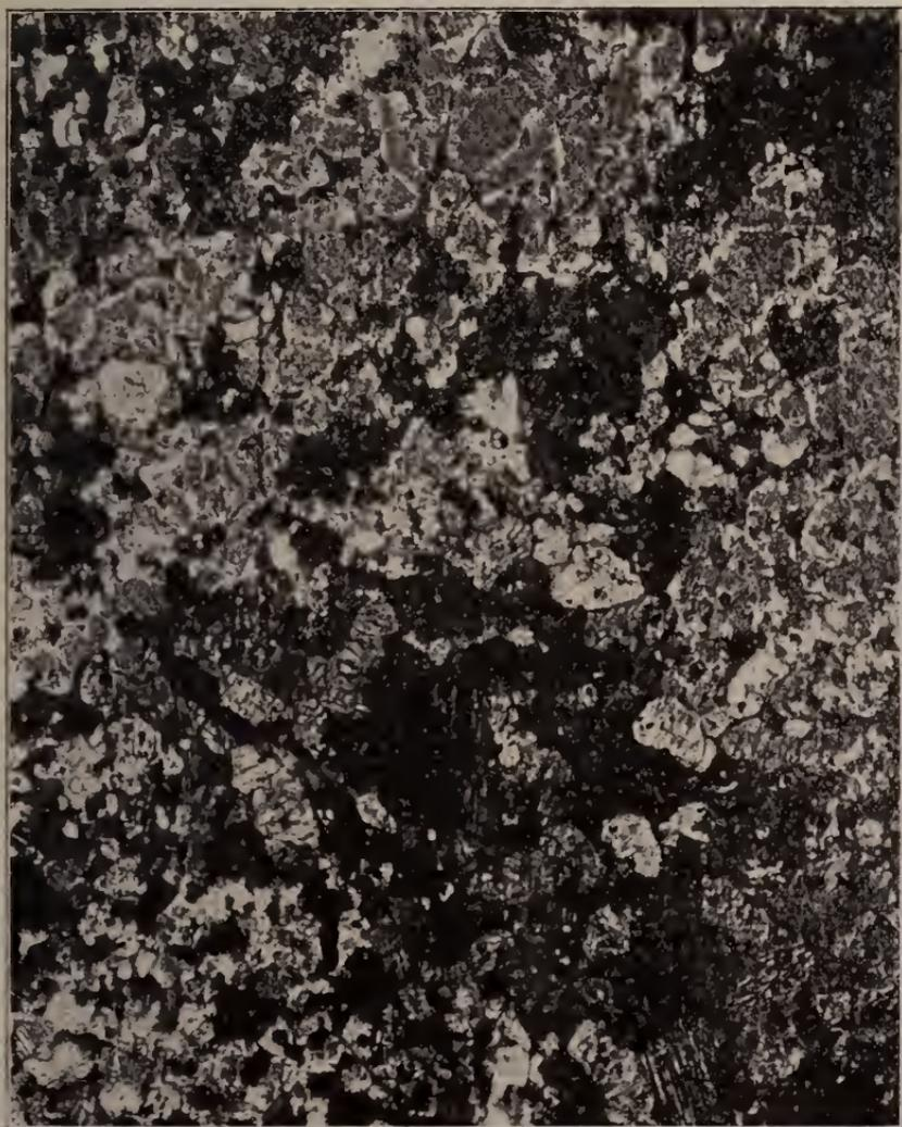
Fig. 7. Dünnschliff des umkristallisierten Dumits bei etwas stärkerer Vergrößerung.
