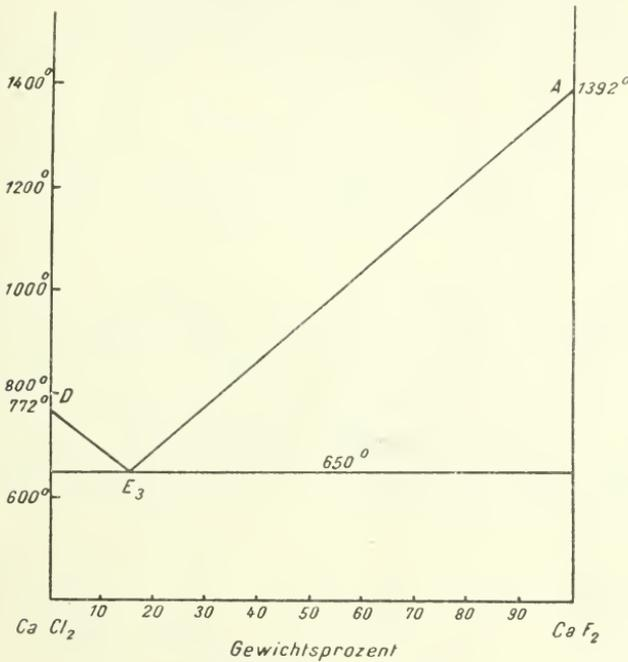
Fig. 3. Das System Calciumchlorid—Calciumfluorid.
