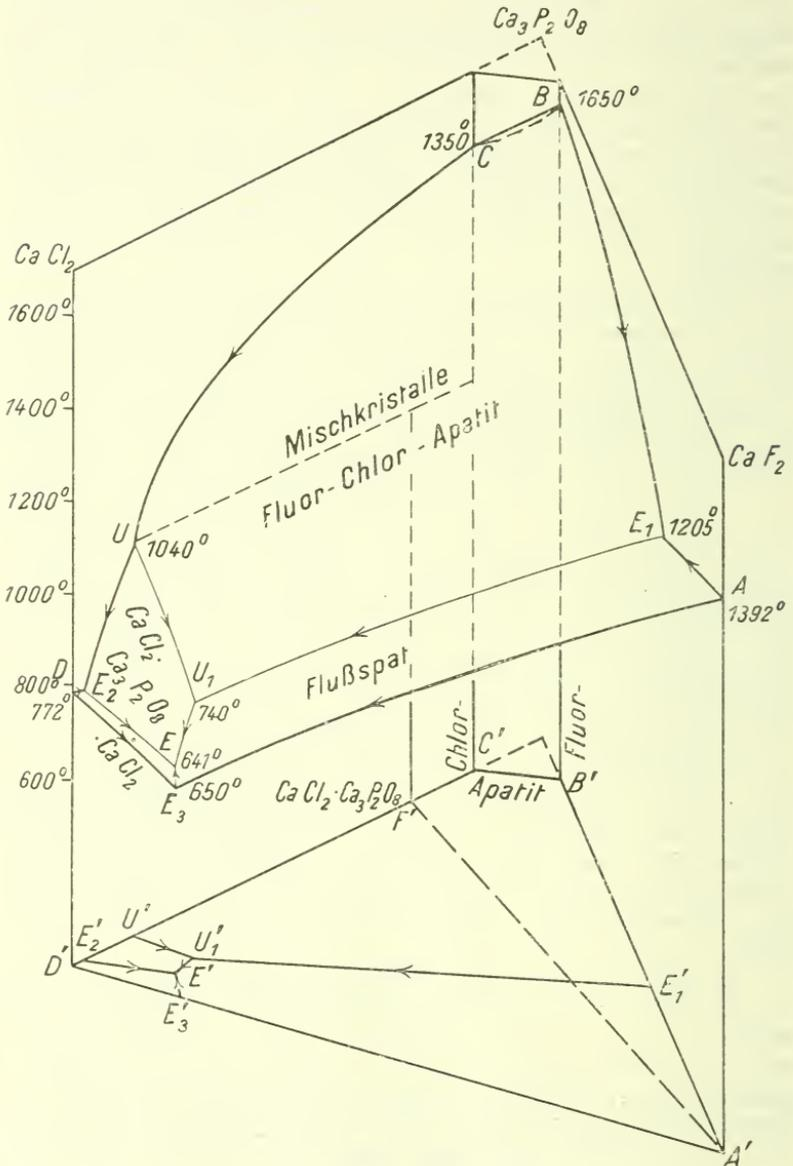
Fig. 5. Kristallisationsvorgänge im System  $CaCl_2$ — $Ca_3P_2O_8$ — $CaF_2$ .
