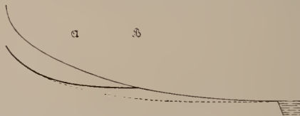
Fig. 2. Die alte Gefällskurve eines Flusses (volle schwache Linie), die neue Gefällskurve nach dem Erhöhen des unteren Denudationsniveaus bis zu B (starke Linie), die mutmaßliche Gefällskurve beim Ausbleiben dieses Erhöhens (gestrichelte Linie). Die beiden letzteren nach dem Ablaufe eines großen Teiles des Erosionszyklus gedacht.
