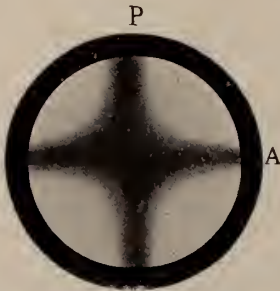
Fig. 2. Gesichtsfeld des Mikroskops bei eingeschaltetem Kompensator in der Null-Stellung.
