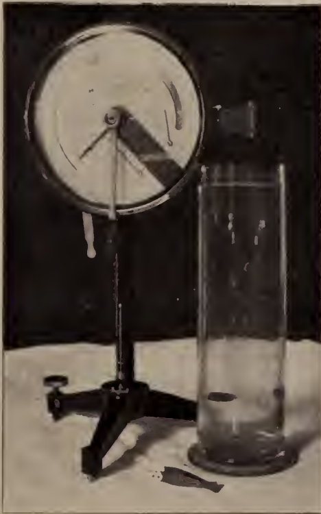
Fig. 6. Torsionswage für 150 Milligramm.
