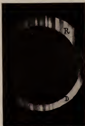
Fig. 11—12. Wie Fig. 8 bei einem Einfallswinkel von ca. 85^\circ . Außer der Beugung des durchgehenden Lichtes (D) zeigt sich auch die Beugung des reflektierten Lichtes (R).
