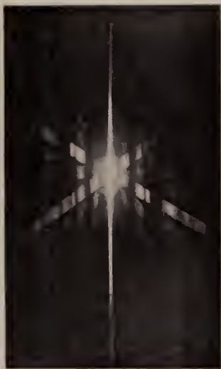
Fig. 21. Beugungserscheinung durch drei unter 60^0 gekreuzte Gitter bei senkrecht einfallendem Licht.
