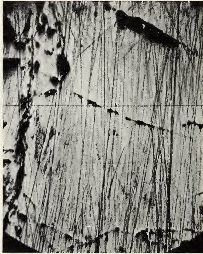
Fig. 10. Tesseralkies von Skutterud. Vergr. 1:50. (Wiederholt aus „Mikroskopische Untersuchung“ etc.)
