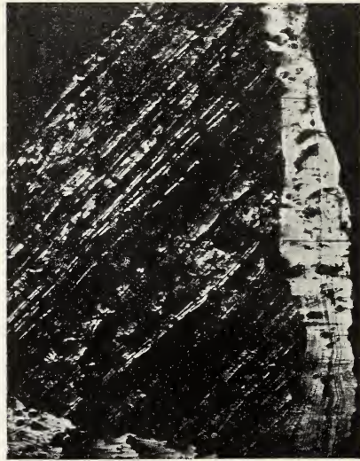
Fig. 12. Sekundäre Spaltenausfüllung im Speiskobalt von Schneeberg. Vergr. 1 : 50.
