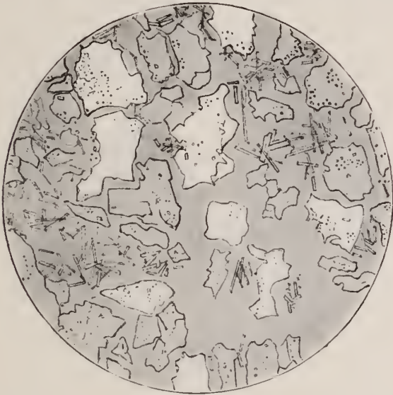
Fig. 1. Angeschmolzene Quarzkristalle mit Einschlüssen in einer Glasmasse mit Sillimanitnadelchen. Vergr. \times 225 .
