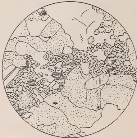
Fig. 4. Erlan. Vyhledy bei Nepomuk. Die Form des diopsidischen Pyroxens (in der Mitte) ist ganz unregelmäßig. Vergr. 42.
