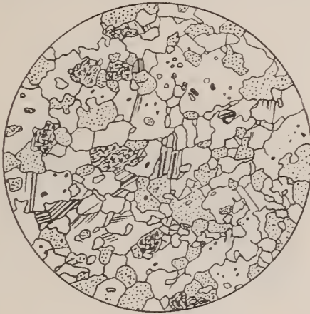
Fig. 2. Erlan. Teufelsbrücke bei Waldmünchen. Quarz (punktiert), Pyroxen (mit Spaltrissen), Feldspat (mit Zwillingslamellen, sonst leer). Vergr. 26.
