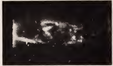
Fig. 10. Wie in Fig. 9, jedoch 3 Std. auf 250° exponiert. Deutliche Nebelentwicklung. Vergr. 100 \times .
