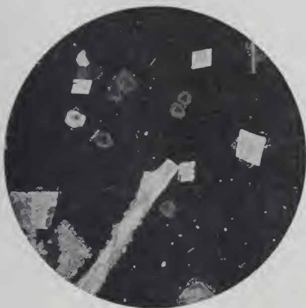
Fig. 2. Kalisalpeter, Kristalle der rhomboedrischen Modifikation frisch (oben) und umgewandelt (unten) und ein prismatischer Kristall der rhombischen Modifikation; an dessen Spitze ein durch die Berührung umgewandelter rhomboedrischer Kristall. Präparat hergestellt 20. X. 1893, photographiert 12. XII. 1918. Bei gekreuzten Nicols aufgenommen. Vergr. 54fach.
