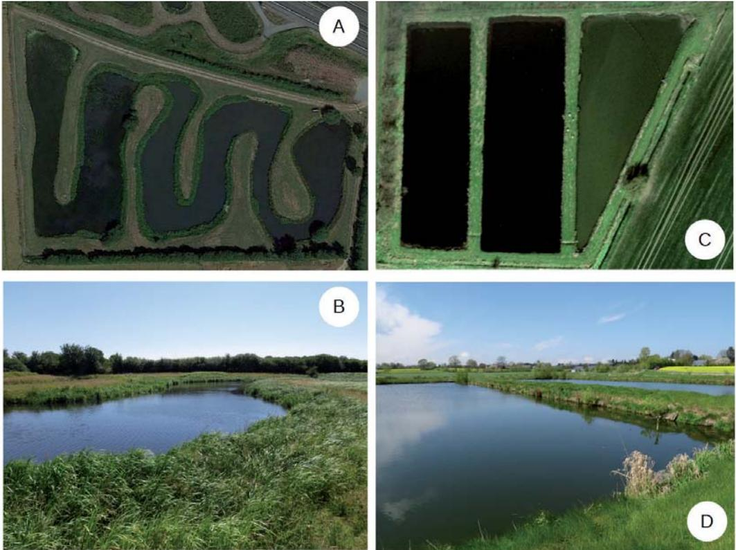
Abb. 2: Klärteiche zeigen erhebliche Unterschiede bezüglich ihrer Form und Ufervegetation. Das Spektrum reicht von S-förmigen Anlagen mit komplexer Uferlinienführung und üppigem Uferbewuchs (A und B) bis zu einfachen rechteckigen Formen und spärlich bewachsenen Uferzonen (C und D).
