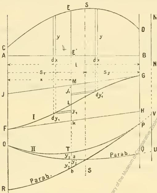
Ist in Fig. 14 die der gegebenen Curve  $CED$  zugehörige erste Integralcurve  $FLG$  sammt ihren Basen  $JG$  und  $FH$  verzeichnet, so wird der Integrator, falls die Umfahrung in der Reihenfolge  $JGLFH$  (oder in der umgekehrten) bewerkstelligt wird, drei Curven verzeichnen, und zwar die beiden, den geraden Basen  $JG$  und  $FH$  entsprechenden Parabelstücke (siehe Nr. 20)  $RP$  und  $OQ$  und die zweite Integralcurve  $OTP$ .
