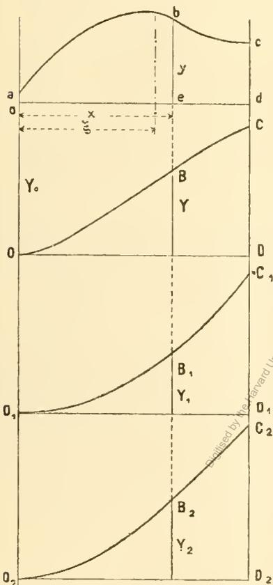
Nr. 16. Noch bequemer lässt sich diese Art der Einstellung zu Zwecken der Flächen- und Momentenbestimmung benützen, wenn man die gegebene Curve vorerst mit dem gewöhnlichen Integrator (nach Nr. 1) umfährt. In Fig. 5 ist die Curve  $OBC$  auf diese Weise aus der Curve  $abc$  erhalten worden, deren  $x$ -Achse  $od$  in der Nullachse angenommen wurde.
