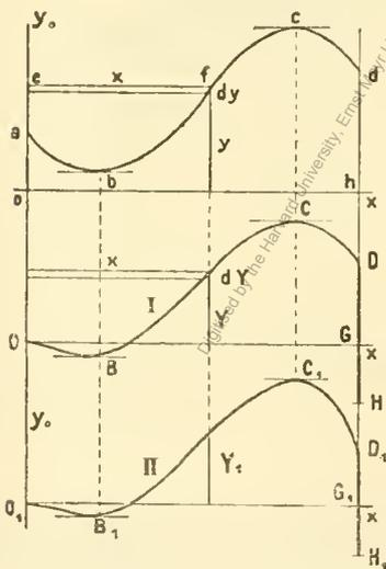
Beschreibt man mit dem Umfahrungsstifte das Stück  $ab$  einer verticalen Geraden, so verzeichnet der Integrator ebenfalls eine verticale Gerade, deren Länge proportional ist dem Flächeninhalte des zwischen  $ab$ ,  $y_0$  und den beiden, den Punkten  $a$  und  $b$  zugehörigen Horizontalen eingeschlossenen Rechteckes.
