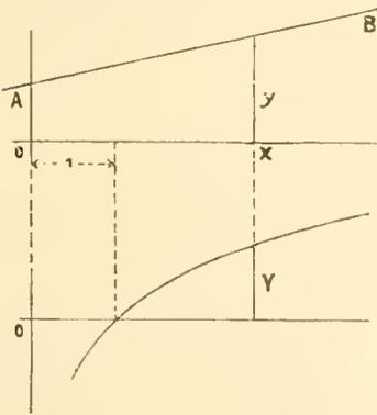
und wird, der Bedingung in Nr. 9 entsprechend, die Anfangsordinate in die der Nullstellung ( $\rho = 0$ ) entsprechende Nullordinate verlegt, so wird beim Umfahren der Geraden der Integrator die Curve
