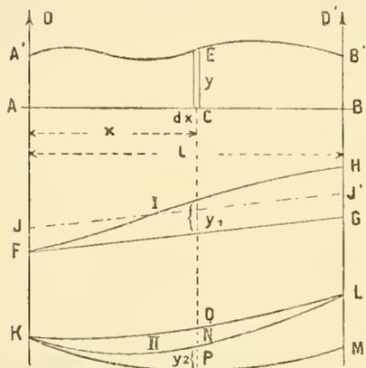
Verzeichnet man zur Belastungslinie die erste Integraleurve  $FH$  mit der unteren Basis  $FG$ , ferner die zweite Integraleurve  $KNL$  sammt ihrer Basis  $KM$ , so stellt  $c \cdot y_1$  die Fläche  $AA'EC$  und  $c^2 \cdot y_2$  das statische Moment dieser Fläche in Bezug auf die Ordinate  $y$  vor; dem entsprechend ist  $c \cdot \overline{GH}$  der ganzen Belastungsfläche und  $c^2 \cdot \overline{ML}$  deren statischen Momente in Bezug auf die Endordinate  $B$  gleich.
