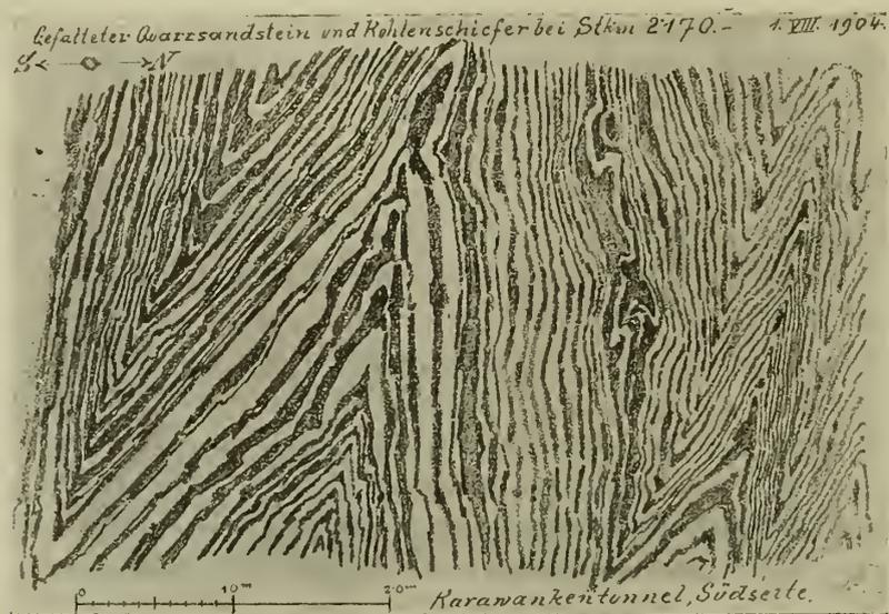
Spitzbogige Falten in einem Wechsel von schwarzem Kohlschiefer mit dünnbankigen hellen Quarzsandsteinen des Obercarbons bei Stm. 2170.
