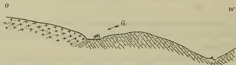
Ost-Westschnitt durch das Bahngelände bei der Station Ausschlag-Zöbern.
