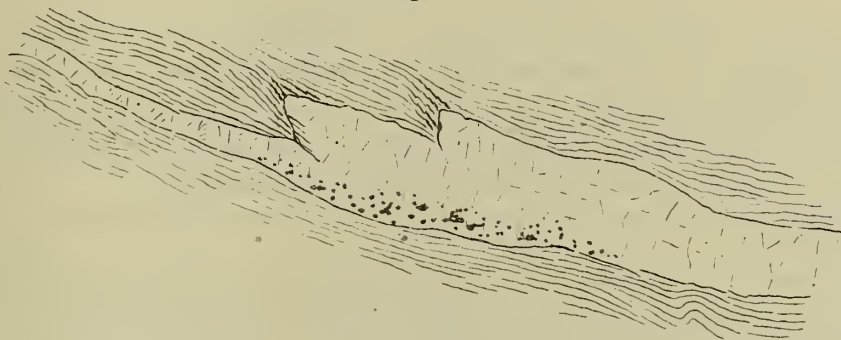
Ansicht des Kupferkies führenden Quarzlagerganges am linken Ulm des Gerichtsbergtunnels bei Stollenmeter 25.
