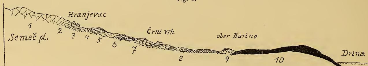
1. ungechichteter grauer Triaskalk, 2. Han-Bulogkalke, 3. roter Sandstein und Schiefer, 4. dünnbankige graue und rotfleckige Kalke (Han-Bulogkalke), 5. rote und grüne Mergel- und Kalklagen (fossilführend), Sandstein und Quarzit (Werfenerschichten), 6. grünliche Tuffe und Diabaslagen, Hornsteine, im unteren Teile Porphyrlagen, 7. hellrötliche Kalke, ähnlich den Han-Bulogkalken, 8. Diabas, Hornstein und tuffitische Sandsteine (Diabashornsteinformation), 9. Kreidekalke, 10. Serpentin.
