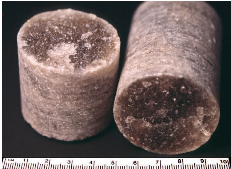
Abb. 2: Steinsalz-Bohrkerne aus dem Bergwerk Altaussee, aus ca. 700 m Tiefe stammend.
