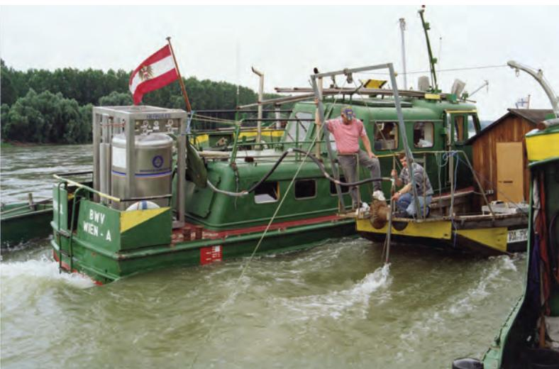
**Abb. 46:** Benthosprobenentnahme an der Donau. Archiv Uwitec.
