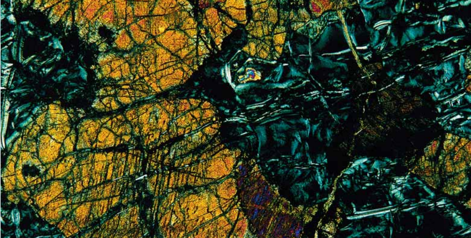
DÜNNSCHLIFF EINES GESTEINS Drei Hundertstel Millimeter dick sind die Dünnschliffe, die die Präparatoren herstellen. Das Gestein ist nun durchsichtig. Im Mikroskop (10fache Vergrößerung, gekreuzte Polfilter) lassen sich die Gemengteile des Gesteins – hier: Olivin aus Erdmantelgestein, Oman – genau bestimmen.
