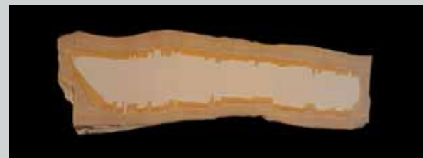
NEUFUND KAHLENBERG , Schnitt durch einen Luftkörper. Die seitlichen Begrenzungen sind Klüfte, die obere und untere sind Schichtflächen. Die eisenoxidhaltigen Lösungen sind von allen Seiten eingedrungen. Die rostfarbige Bänderung und der helle Kern zeichnen etwa den Umriss des Stückes nach. Die feinen Haarrisse erweisen sich als undurchdringliche Barrieren. Der helle Kern wurde von der Imprägnierung nicht erreicht. Mineralogisch-Petrographische Abteilung, NHMW.
