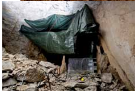
Mit Planen wird Wasser aufgefangen und in einem Messwehr werden Durchflussmenge, Temperatur und die elektrische Leitfähigkeit gemessen.
