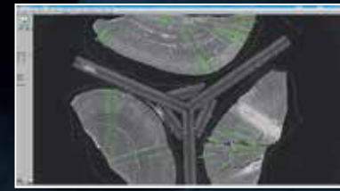
CT-Querschnitt durch Stiegenteile mit einge- tragenen Messstrecken
