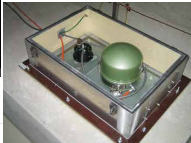
Ein Breitbandseismometer (grün) mit einem Bewegungssensor für starke Bodenbewegungen (schwarz)
