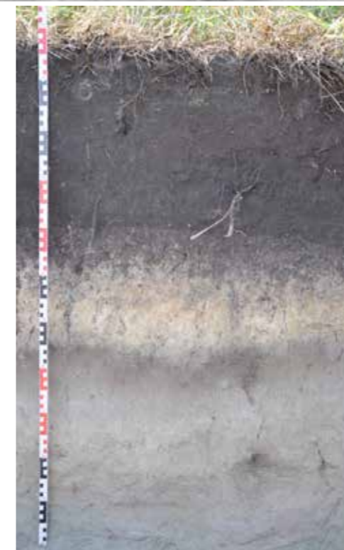
Das geologische Profil nördlich des awarenzeitlichen Gräberfeldes von Podersdorf zeigt unter dem Ackerboden auffällig helle, feinsandig-tonige Seesedimente mit zahlreichen Mollusken und Ostrakoden.
