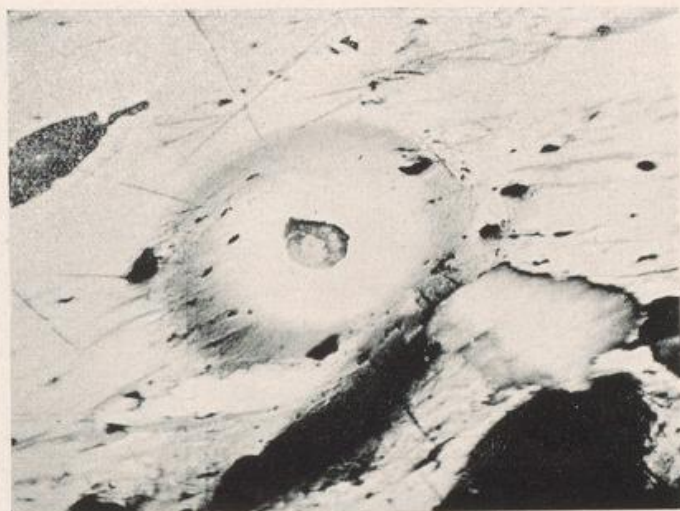
Abb. 39 Flöz Karl-Unterbau, Schacht Emil-Emscher. Zirkon mit Kontakthof in Kohleschliere (hell) des Tonsteins (dunkel). Anschliff. V = 250.
