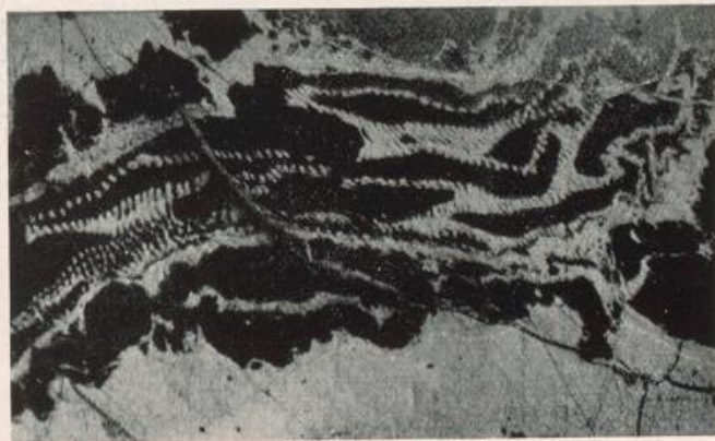
Abb. 44 Flöz wie vor. Treppentracheiden größtenteils von Kaolin verdrängt. Anschliff, V = 250.
