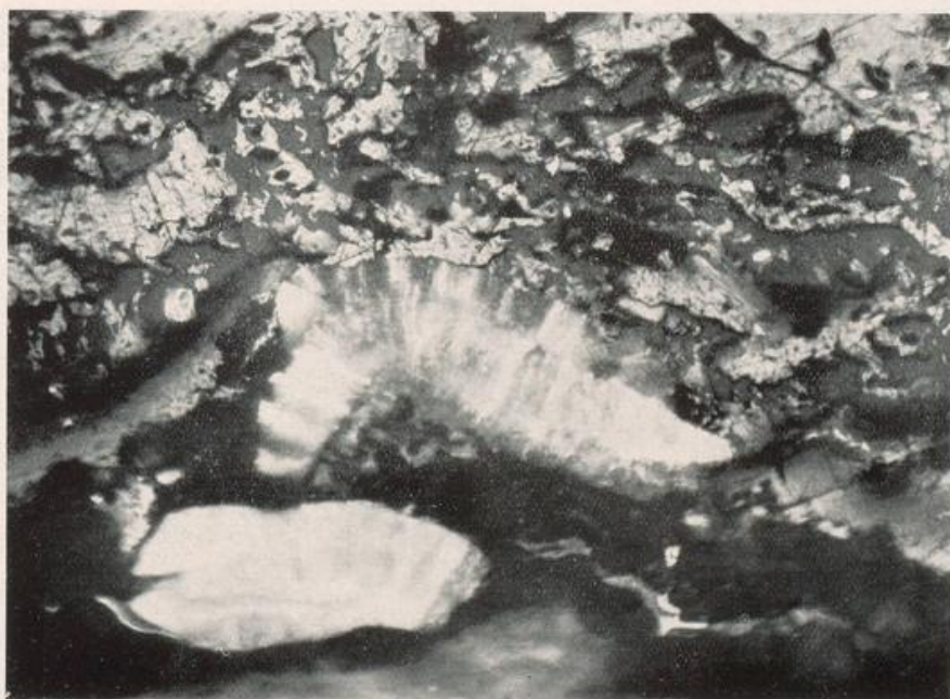
Abb. 32 Flöz wie vor. Kaolingraupen und -wurm in vitritischer Kohle. Anschliff. V = 250.
