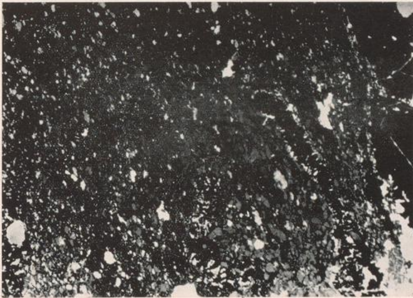
Abb. 19 Tonstein w. v. Typische Struktur eines Kristalltonsteins. Auf Korngrenzen dunkler Schlieren fasrige Säume eines stark lichtbrechenden (Kaolin?) Minerals. Dünnschliff. V = 11.
