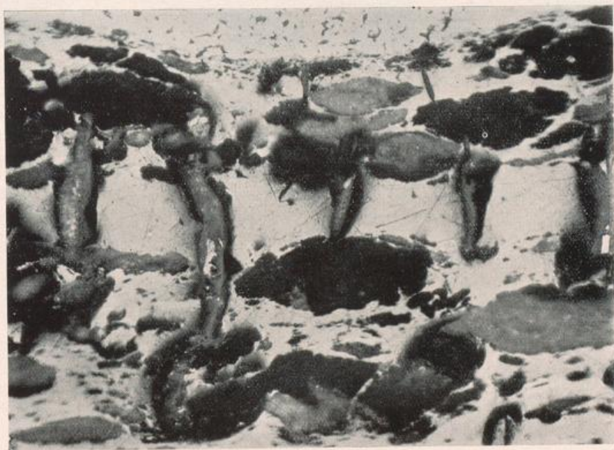
Abb. 48 Flöz Wilhelm, Schacht Fritz Heinrich. Kaolinlinsen im Vitrit und mit Quarz gefüllte Schwundrisse. Anschliff. V = 250.
