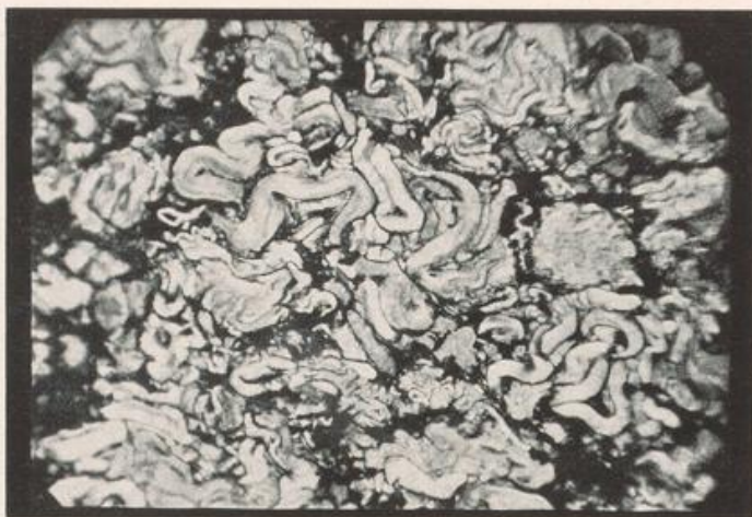
Abb. 21 Tonstein Flöz Johann 1, Zeche Dorstfeld. Prächtiger Kristalltonstein fast nur aus wurmförmigen Kaolinitkristallen bestehend. Dünnschliff parallel zur Ablagerung. V = 150 .
