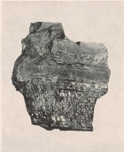
Abb. 11 Tonstein Flöz Karl-Unterbank (Mitte), Zeche Friedrich Joachim, im Hangenden ein Brandschieferpacken. V = 1/2 .
