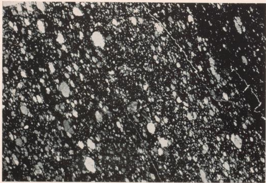
Abb. 26 Tonstein Flöz Wilhelm, Zeche Consolidation. Kristalltonstein mit schichtig geregelten Kaolinitkristallstreifen. Dünnschliff. V = 11 .
