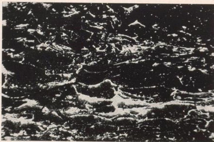
Abb. 46 Flöz wie vor. Vitritische Verdrängungsreste im Kaolin (feinste Zellwandreste). An- schliff. V = 250.
