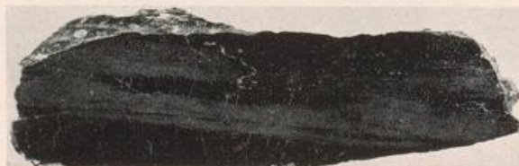
Abb. 13 Tonstein Flöz Johann I, Zeche Dorstfeld bei Dortmund. Linsenförmige Auflösung des fast nur aus Kaolinwürmern bestehenden Kristalltonsteins in der Kohle. V = 1/2 .
