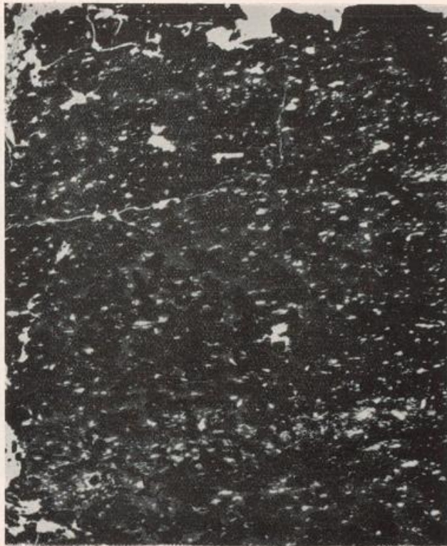
Abb. 27 Tonstein Flöz Wilhelm, Zeche de Wendel, Hamm. Kristalltonstein mit Kaolin- und viel Quarzkristallen. Dünnschliff. V = 11.
