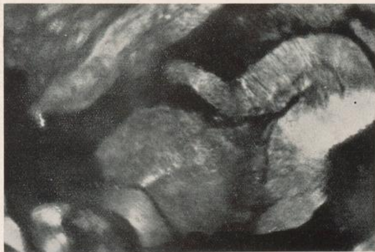
Abb. 24 Tonstein wie Abb. 21. Knäuel-förmig in situ gewachsene Kaolinitkristalle. Dünnschliff bei 1/2 gekreuzten Nicols. V = 250 .
