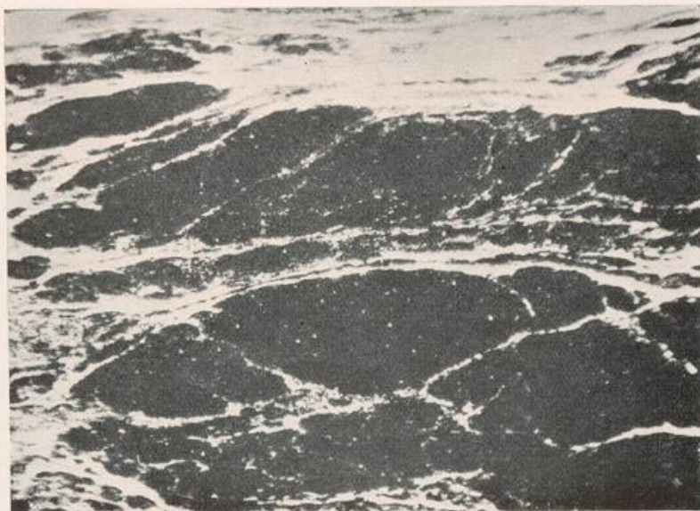
Abb. 47 Flöz wie vor. Kaolinlinsen. Anschliff. V = 250.
