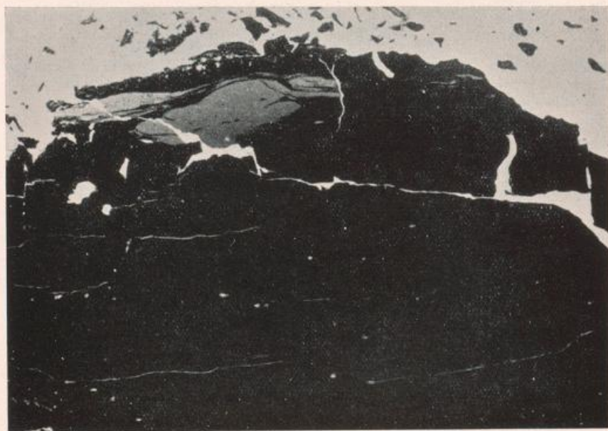
Abb. 18 Tonstein Flöz Karl-Unterbau, Zeche Friedrich Joachim. In der an diesen Kristalltonstein angrenzenden Kohlepartie befinden sich eigenartige helle Kaolinschlingen und -schlieren. Dünnschliff. V = 11.
