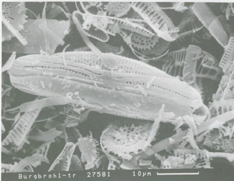
Abbildung 1. Raster-Elektronenmikroskop-Aufnahme eines Streupräparates der Kieselgur aus dem Brohltal-Trass. Groß im Zentrum eine *Amphora*, in der Umgebung *Cyclotella*, *Fragilaria brevistriata* und Bruchstücke von *Cymbella* sp. Länge des Maßstabsbalkens: 10 Mikrometer.
