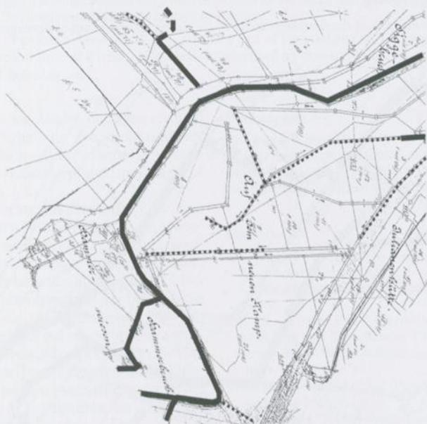
Abbildung 3. Katasterkarte von 1896, nördlicher Teil des Vorbeckens („Auf dem neuen Kamp“) (das Bild wurde gedreht und verzerrt, um etwa die gleiche Perspektive wie Abb. 2 zu erhalten). Dicke, durchgezogene Linien: wasserführendes altes Bachbett. Dicke, gestrichelte Linien: wasserführendes neu entstandenes Bachbett. Dünne, gepunktete Linien: trockenliegende im Gelände erkennbare Gräben
