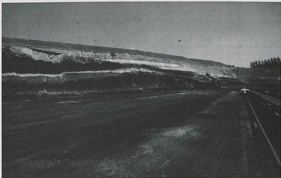
Abbildung 17. Braunkohlengrube "Neurath-Nordfeld": Überschiebungen in Sand und Braunkohle. Figure 17. Browncoal-Pit "Neurath-Nordfeld": thrusts in browncoal and sand.
