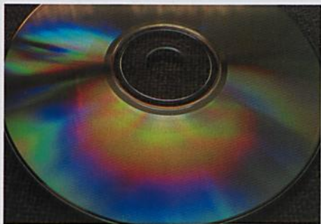
Abbildung 10. Das Farbenspiel der Lichtreflexion an einer CD entsteht durch Interferenz an dünnen Schichten. Aus den Reflektionswinkeln lassen sich Schichtdicken (bei der CD auch Spurbstände) berechnen.
