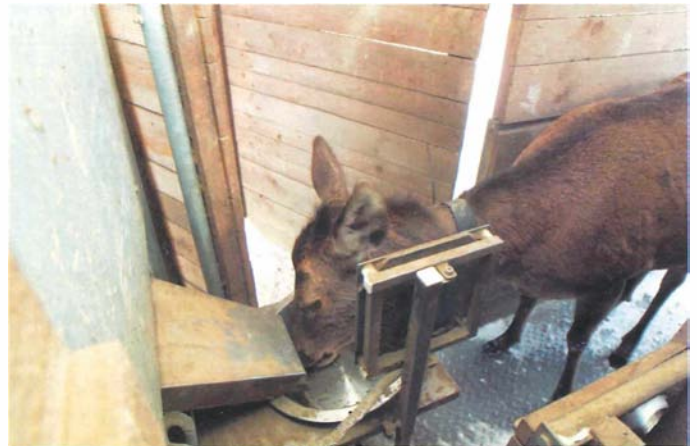
Abb. 3 Diese automatische Fütterungsstation ermöglicht es Rotwild mit zwei verschiedenen Futtertypen zu versorgen, bei jedem Besuch zu wiegen und die Nahrungsaufnahme zu messen.
