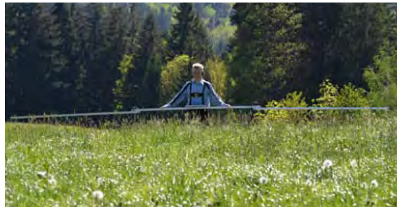
Das praktische Handgerät im Einsatz: Bei einer Arbeitsbreite von sieben Metern, einer Infrarot-Sensorzahl von sechs Stück und einer Energieversorgung über einen PC-Akku, werden die Datenerfassung und die Ausarbeitung wie beim Traktorgerät ebenfalls über einen Tablet-PC erledigt.
