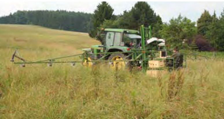
Das Traktorgerät im Einsatz: Bei einer Arbeitsbreite von 15 Metern und einer Einsatzgeschwindigkeit von 10 – 15 km/h wird eine Hektarleistung von etwa 10ha/Stunde erreicht. Möglich machen das 30 Infrarotsensoren und eine Datenaufzeichnung mittels GPS.
