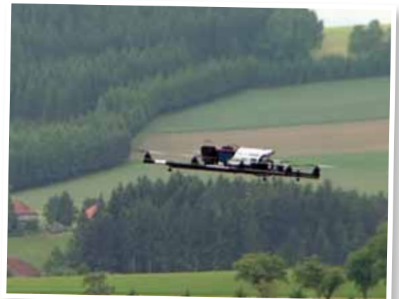
Der Oktokopter – ein mit Infrarot und Digitalka-mera bestücktes Fluggerät zur Kitzrettung. Quelle: ORF OÖ
