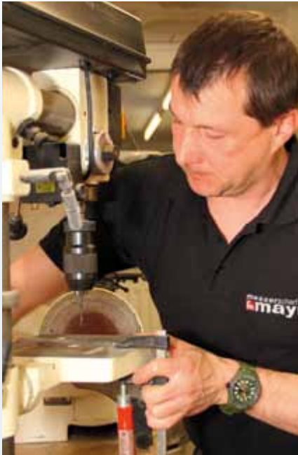
Der Rohling wird gebohrt - dadurch verliert das Messer etwas an Gewicht, bleibt aber trotzdem stabil.
