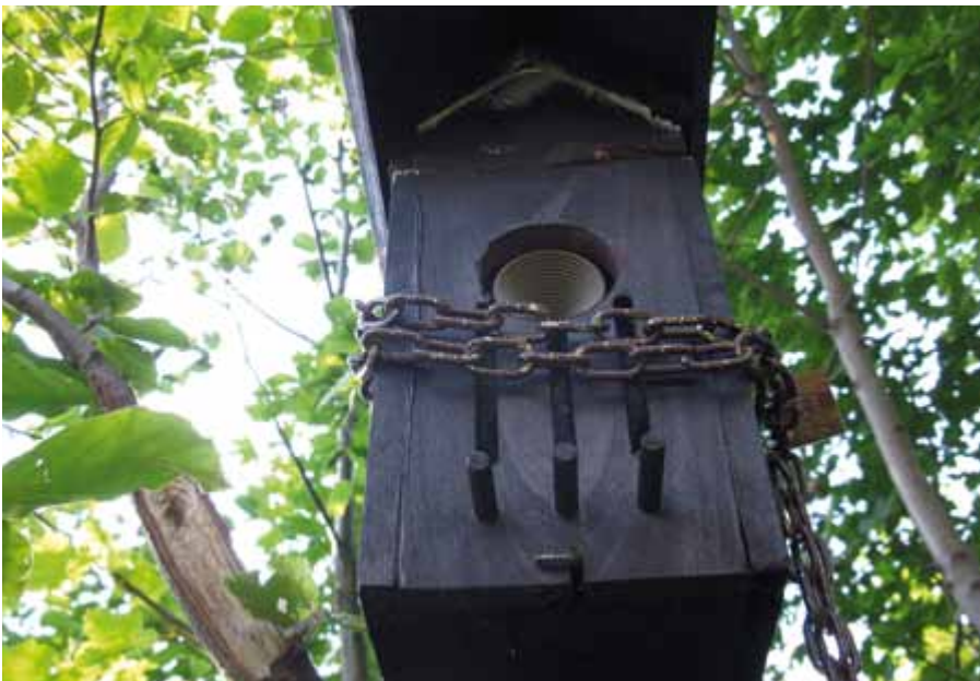
Abb. 1: Die Zeitrafferkameras wurden in umgebaute Insektenhotels montiert und diese in 3m Höhe am Baum befestigt. An den betreffenden Standorten wurde durch Hinweisschilder auf den Wildkameraeinsatz für Forschungszwecke hingewiesen.
