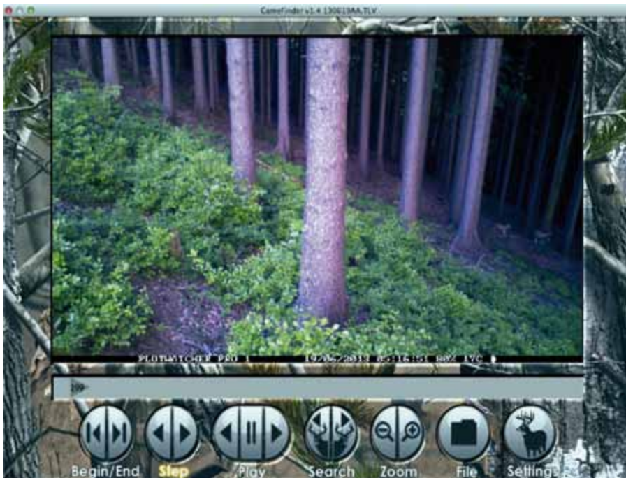
Abb. 2: Der Beginn der täglichen Aufnahmen der Zeitrafferkameras startet abhängig von einer vorgegebenen Lichtintensität, wie sie auch abends ebenso ab einer bestimmten Intensität endet. Beide Funktionen sind fix eingestellt und durch einen Sensor der Kamera gesteuert. Die gespeicherten Bilder werden automatisch zu einem Zeitrafferfilm zusammengefügt.
