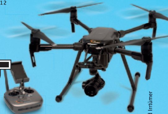
Thermalkamera Zenmuse XT 2 Videoformat 640 x 512
