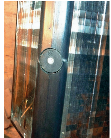
Abb. 2: Hier hat eine Mauerbiene ganze Arbeit geleistet und das Mikrofon „zugemauert“. Vorsichtiges Abkratzen ist hier gefragt – doch Vorsicht, damit die Membran nicht zerstört wird.
