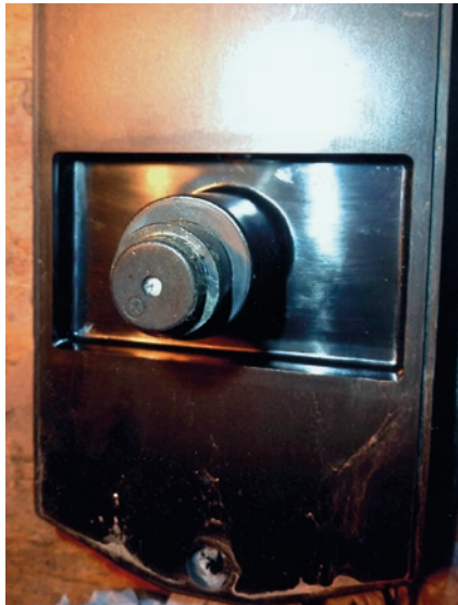
Abb. 1: Eine Spinne hat sich einen „Nistplatz“ eingerichtet und einen Kokon im Mikrofon angelegt. Hier darf nicht mit Draht und dergleichen gearbeitet werden, sondern mit einem Grashalm oder einer Plastikborste vorsichtig der Kokon entfernt werden, damit die Mikrofonmembran nicht zerstört wird.
