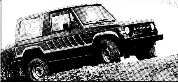
Das ist die neue Klasse in der Allrad-Klasse. Steigfähigkeit 80%. Neigungswinkel (längs) 45 Grad. Bodenfreiheit 210 mm. Wattiefe 400 mm. Komfort durch «Schwebesitz». Kraft aus Turbodiesel oder Benzinmotor: 84 oder 103 PS.
