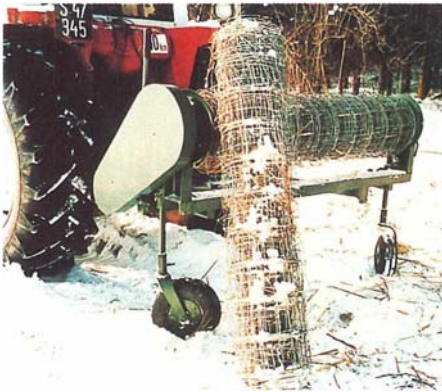
Zaunwickelgerät (bis zu 3 Meter Arbeitsbreite)
