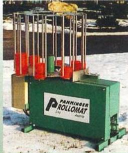
Rollscheibenmaschine mit Fernauslösung und einstellbaren Geschwindigkeiten. Großes Taubenmagazin.
