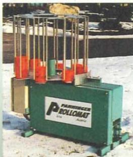
Rollscheibenmaschine mit Fernauslösung und einstellbaren Geschwindigkeiten. Großes Taubenmagazin.
