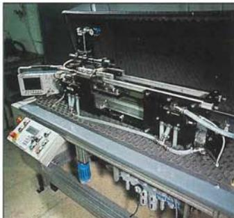
Am Schocksimulator wird das Zielfernrohr auf seine 100%ige Funktionsfähigkeit getestet.
