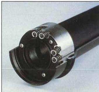
Im Moment der Schußabgabe wirkt kurzzeitig die 500- bis 800-fache Gewichtskraft des Umkehrsystems auf das Innenleben des Zielfernrohres. Nach einer kurzzeitigen Abwicklung von ca. 0,3 mm wird das Umkehrsystem in 2 bis 4 Millisekunden wieder exakt ausgerichtet.
