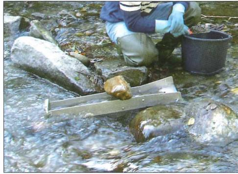
**Abb. 5:** Vorgesiebter Schotter (Korngrößen bis ca. 2 cm) wird über eine Schleuse ausgewaschen.
